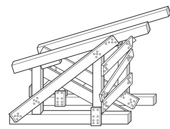
FIGURE A.6.4.3(6)(d) Sloped Floor Shore Type 3.
