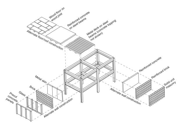
FIGURE C.1(d) Steel Moment-Resisting Frame.
